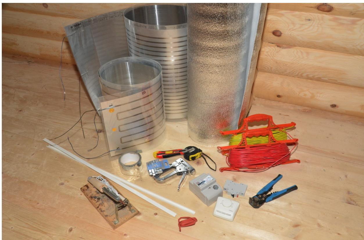
Предварительно замеряют участки потолка и нарезают изолон нужного размера. После чего с помощью степлера материал крепят к потолку. Швы между отдельными листами аккуратно заклеивают скотчем.
