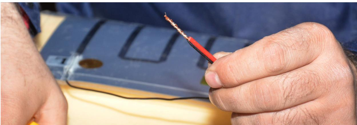
Лишнюю часть, примерно треть, отрезаем и приступаем к паянию. Предварительно обезжириваем поверхности с помощью кислоты.
